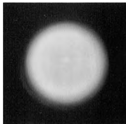
従来の球面レンズスポット投光面 【中落ち-中心部が暗い-がある。】
